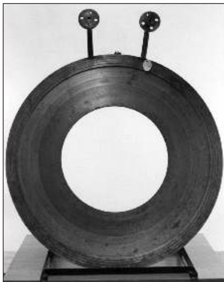
Bild 3 Nicht genormte Meßblende aus den Leuna-Werken. Einsatzort: Abgas der (alten) Raffinerie, Nennweite: 800 mm, Blendenöffnung: 450 mm, Einbaulänge: 26 mm
