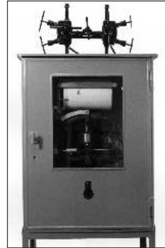
Bild 7 I.G.-Ringwaage mit 7teiligem Umgang im Einbauschränk. Einsatz in den Chemischen Werken Buna für ND-Dampfmessungen im Bau A 92
