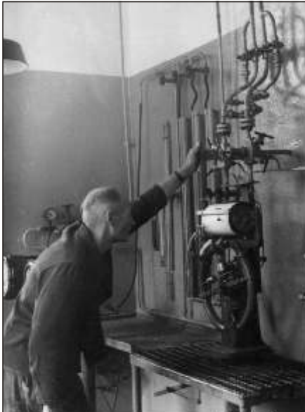
Bild 5 Der Mechaniker Kurt GRÜBNER im Werkstatttraum D 931 der Betriebskontrolle Schkopau beim Überholen einer Ringwaage, um 1950. Er wechselte später in die Ringwaagen-Reparaturwerkstatt der Leuna-Werke über
