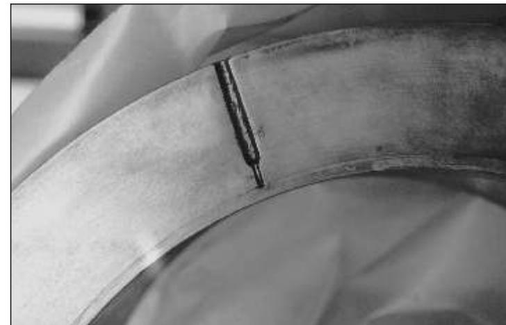
Bild 3 Hochdruckmantel mit Entgasungsbohrungen und Futterrohr aus Weicheisen
