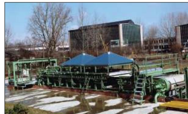
Kautschukbandmaschine, eingesetzt bei der Herstellung von synthetischem Kautschuk in den Buna-Werken Schkopau (Bild links).
