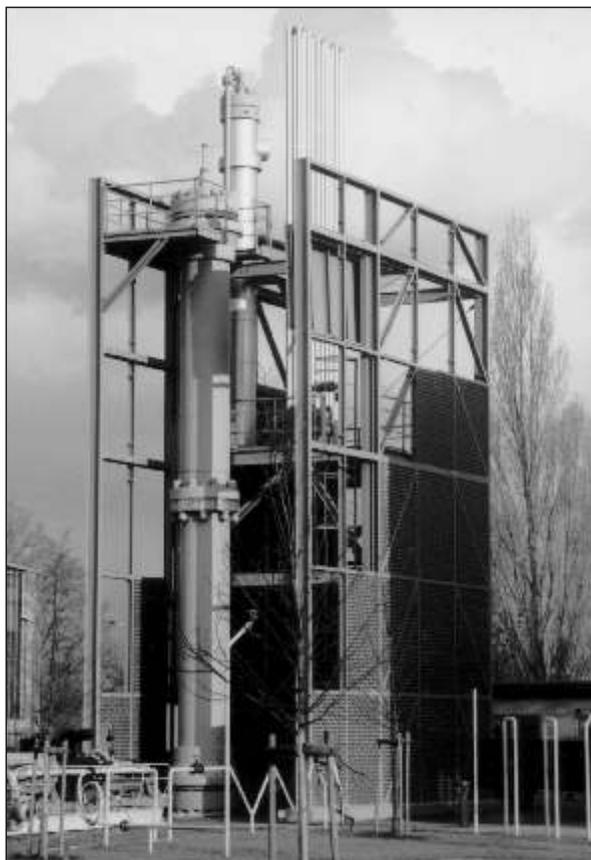
Bild 1 Ammoniak-Synthesekammer mit Reaktor im Vordergrund
