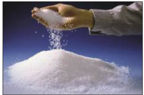
Bild 2 Nach heutiger Technologie hergestelltes weißes Polyamid 6-Granulat
